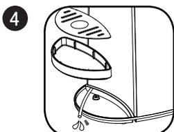
4 水受けトレイ下にありますが、排水チューブのキャップを取り外し、精製水をすべて排出します。
