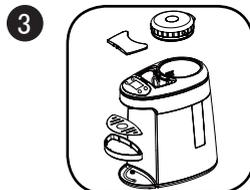
3 精製水フタ、精製水フィルター、上フタを取り外し、水受けフタ、水受けトレイも取り外します。
